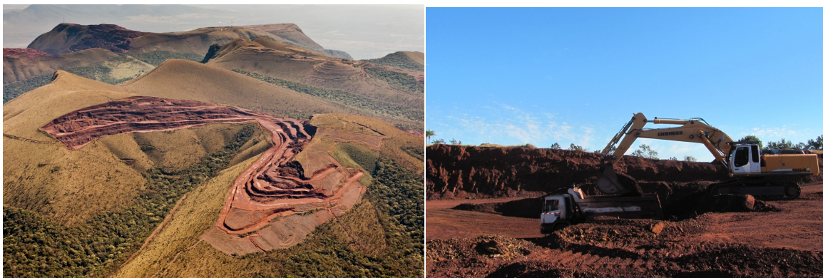
Figuras 8 e 9: Visualização geral de lavra a céu aberto e operação por desmonte mecânico e transporte de MFe
